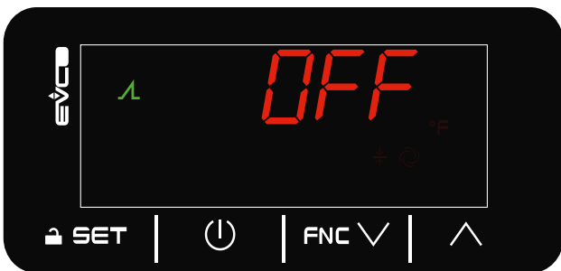
Fig. 28. Funcionamiento proporcional - ID1 e ID2 abierta
