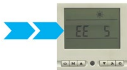
Código de error, EE5, aviso de flujo de agua bajo / alto o interruptor de flujo dañado.
