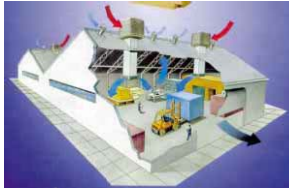
Esquema de instalación en naves industriales
