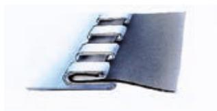
Detalle engatillado tipo LOC-4
