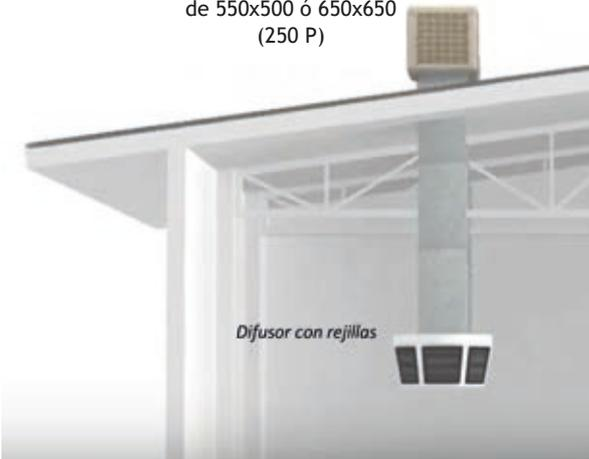
*Si las condiciones del edificio lo permiten, bajar hasta 3 m. del suelo.*
