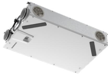
Unidad de ventilación mecánica controlada de doble flujo equipada con motores EC con control de caudal constante, extremadamente silenciosa, de tan solo 19 cm de altura y eficiencia de recuperación hasta 92%
