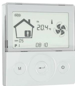
Los recuperadores de calor TECNA SABIANA ENY-TH pueden ser gestionados de manera sencilla mediante el **control de pared con pantalla de cristal líquido T-EP** (accesorio opcional no suministrado) desde el cual es posible seleccionar un modo de funcionamiento manual o automático, las velocidades de giro de cada ventilador, la compuerta de bypass, una batería de agua o una resistencia eléctrica externa.
