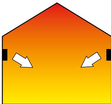
La temperatura del aire en una nave industrial aumenta del 0,7 a 1,5 °C por cada metro de altura, llegándose a alcanzar en algunos casos temperaturas en el techo de hasta 40 ó 50° C.
