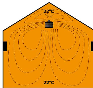
Instalando **ELITURBO** el aire caliente se distribuye uniformemente, reduciendo la dispersión de calor y el consumo de combustible hasta en un 30 o 40%, dependiendo de la altura del local.
