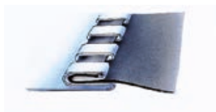
Detalle engatillado tipo LOC-4
